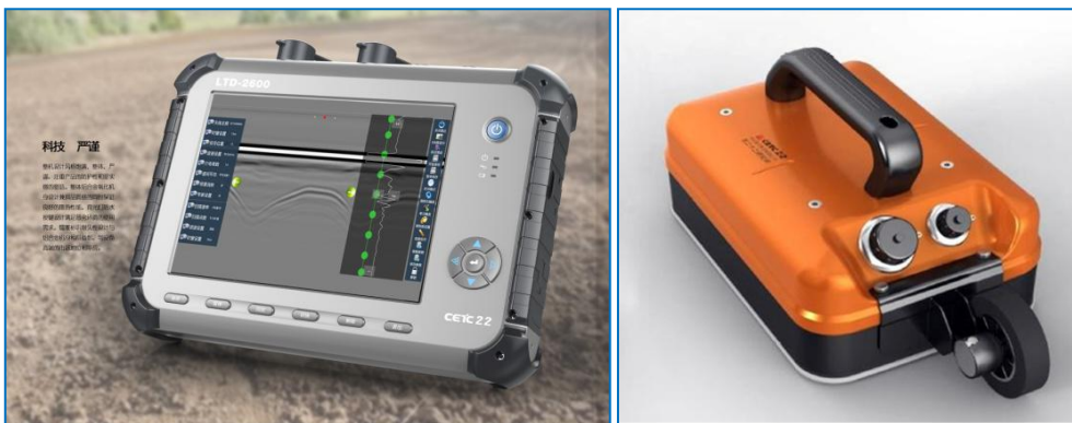
图 2-1 LTD-2600 主机+GC900MHz 屏蔽天线
